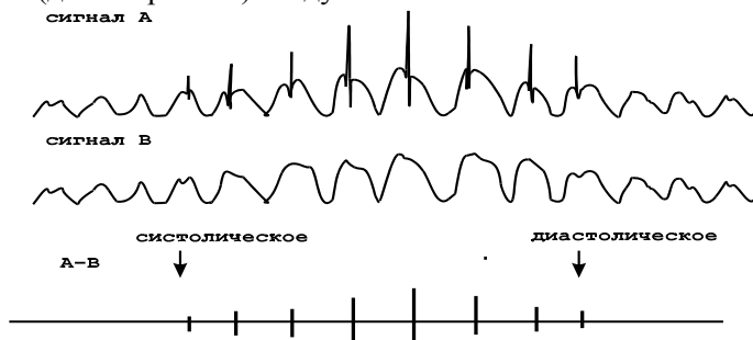
Рисунок 6.4 – Выделение тонов при вычитании сигналов дифференциального датчика
